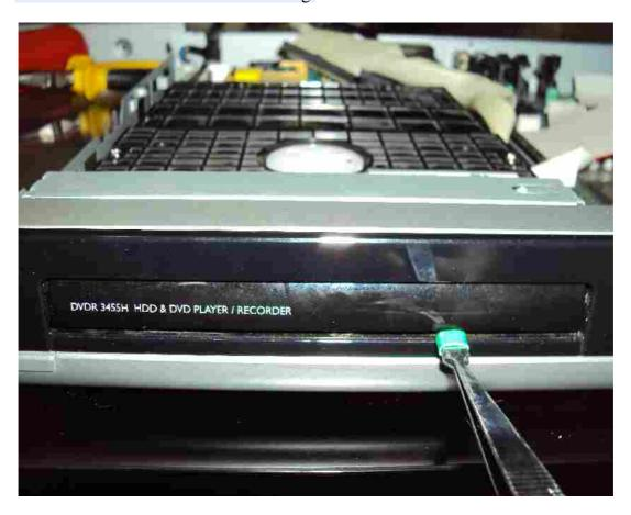
4. Após, retire o leitor de dentro do aparelho:
